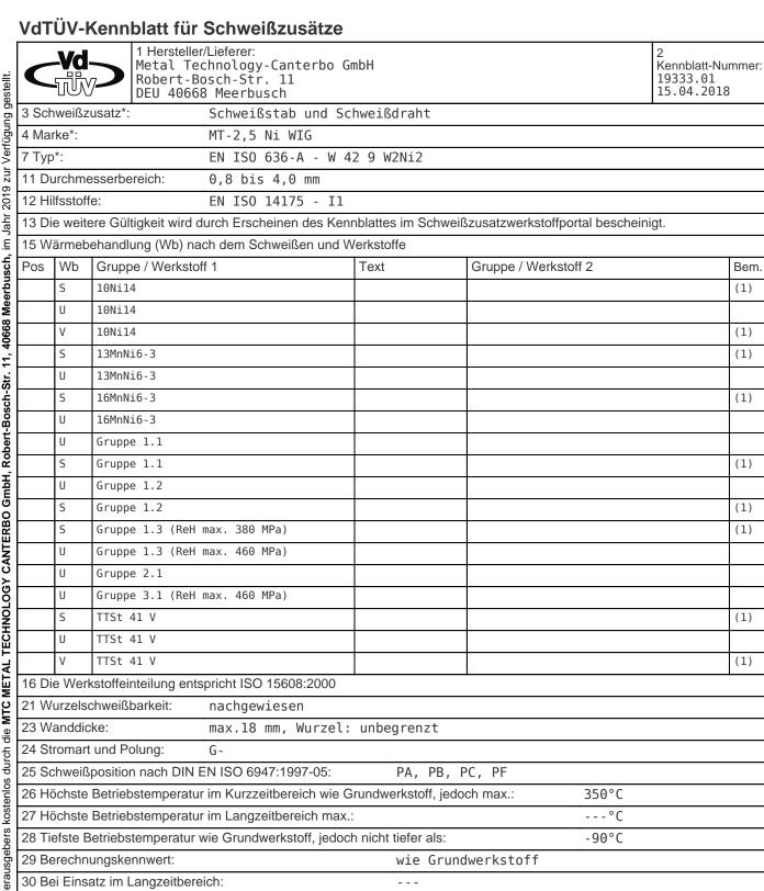
(1) Spannungsarmgeglüht (S) 15h 580°C; Ofen bis 300°C/Luft Vergütet (V) 0,5h 880°C/Luft, 3h 660°C Ofen bis 300°C/Luft.
