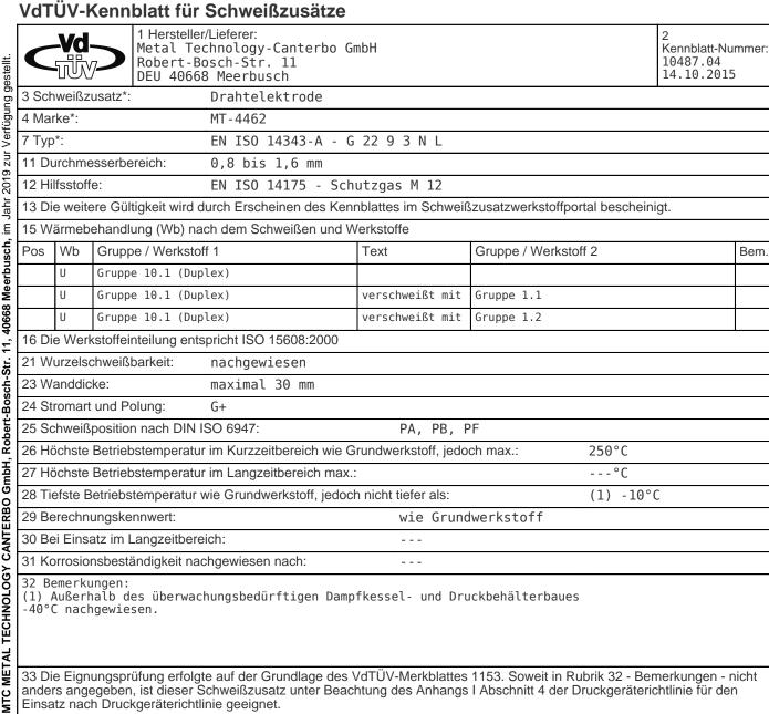
34 Erläuterungen A - angelassen S - spannungsarm geglüht W - weichgeglüht G+ - Gleichstrom Pluspol L - lösungsgeglüht u. abgeschreckt G- - Gleichstrom Minuspol St - stabilgeglüht N - normalgeglüht W - Wechselstrom U - ungeglüht V- vergütet
